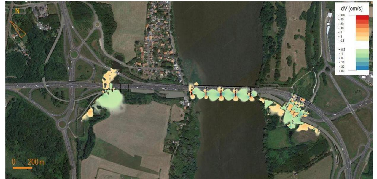
Figure 5 : Evolution des vitesses maximales d'écoulement (cm/s) type 1982 entre la phase projet – variante 2 et l'état de référence post travaux de rééquilibrage du lit de la Loire
