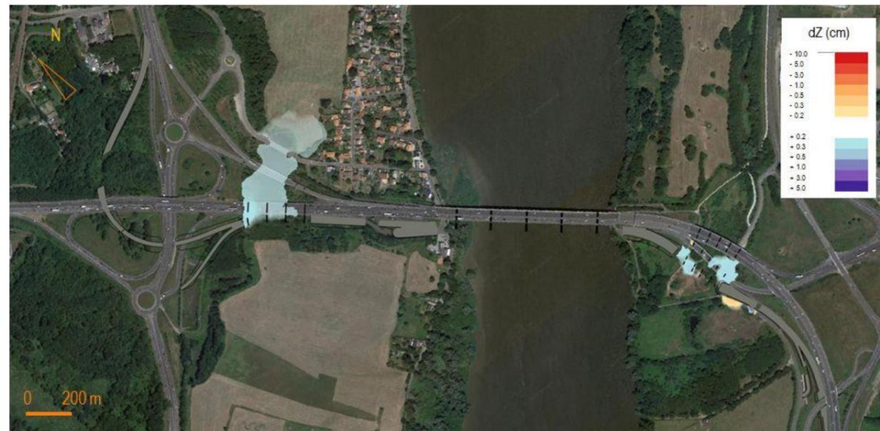
Figure 4 : Evolution des niveaux de crue (cm) type 1982 entre la phase projet – variante 2 et l'état de référence post travaux de rééquilibrage du lit de la Loire
